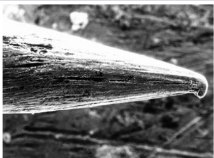
Nadelspitze geschliffen und mit CARBOCHEM-Verfahren geglättet (ca. 190fach vergrößert)
