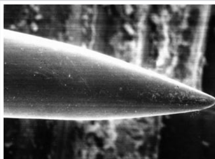
Nadelspitze geschliffen und mit CARBOCHEM-Verfahren geglättet (ca. 190fach vergrößert)
