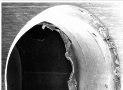
Schnittkante zweier sich kreuzender Bohrungen vor und nach der Entgratung durch CARBOCHEM-Verfahren (ca. 30fach vergrößert)
