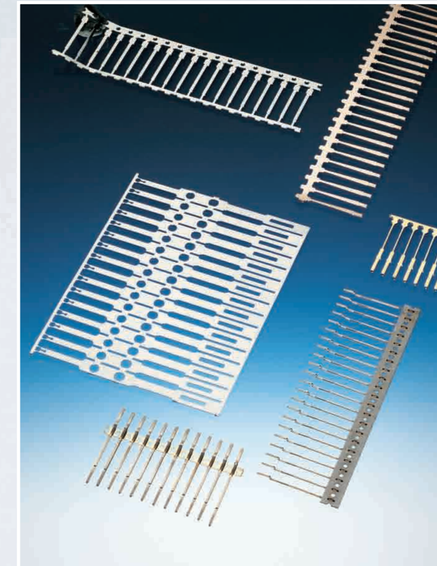
Elektropolierte Kontakbänder aus Bronze, Neusilber, Berylliumbronze, Messing und Kupfer. Bearbeitungsziel: Feinentgratung und verbesserte Galvanisierbarkeit
