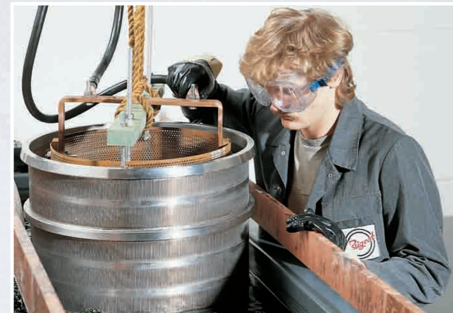
Elektropolieren eines Siebkorbes aus Cr-Ni-Stahl zur Feinentgratung und Glättung der Oberfläche
