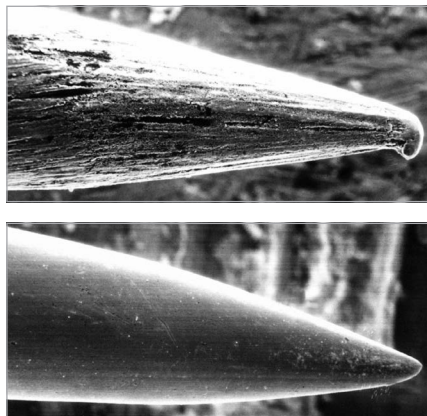
Nadelspitze geschliffen und mit CARBOCHEM-Verfahren geglättet (ca. 190fach vergrößert)
