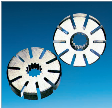
Läufer einer Einspritzpumpe roh und CARBOCHEM-bearbeitet zur Entgratung und Erzielung einer partikelfreien Oberfläche (ca. 0,5:1)
