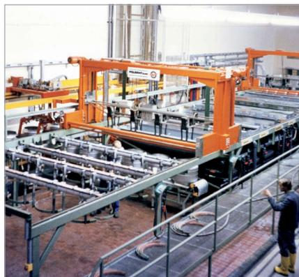
Vollautomatische POLIGRAT-Anlage, Typ EK 3500 AS, zum Elektropolieren von Edelstahltrommeln für Wäschetrockner mit Vor- und Nachbehandlungseinrichtung
