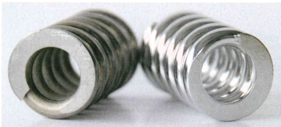
Scharfe Kanten, Grat- und Rissbildung verkürzen die Federlebensdauer (links). Geglättete Oberflächen und verrundete Kanten minimieren die Kerbwirkung (rechts).
