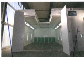
Die überflur ausgeführte Kabine wird unmittelbar auf den Hallenboden aufgebaut und erspart Fundamentarbeiten.
