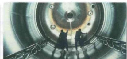
Reinigung eines Reaktors nach dem Elektrolieren
