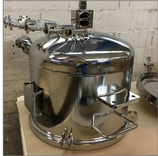
Elektropolierter Titanbehälter für die Pharmaindustrie
