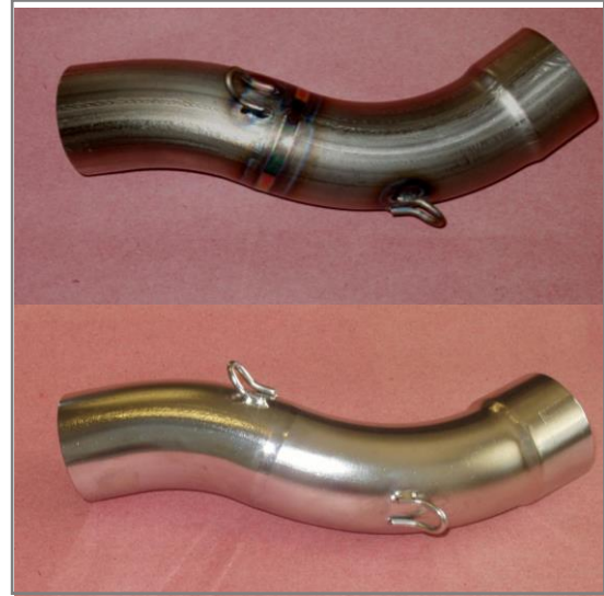
Auspuffkrümmer vor und nach dem Elektropolieren mit POLIGRAT E 392
