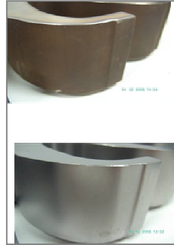
Oberfläche vor und nach dem Beizen mit POLINOX TB 100, Abtrag 70 µm
