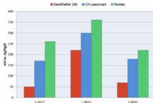
Verbesserte Korrosionsbeständigkeit durch POLINOX Passtec
