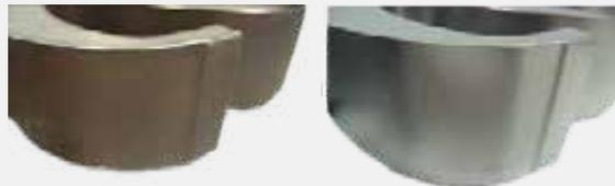
Oberfläche vor und nach dem Beizen mit POLINOX TB 100, Abtrag 70 µm
