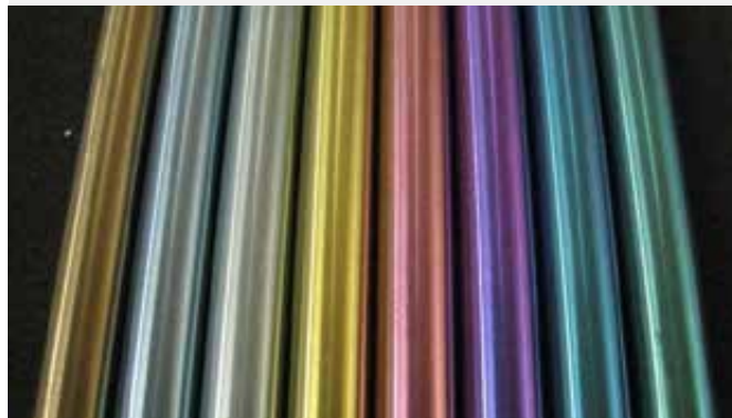
Mit TITAN COLOR I verschieden gefärbte Titanoberflächen
