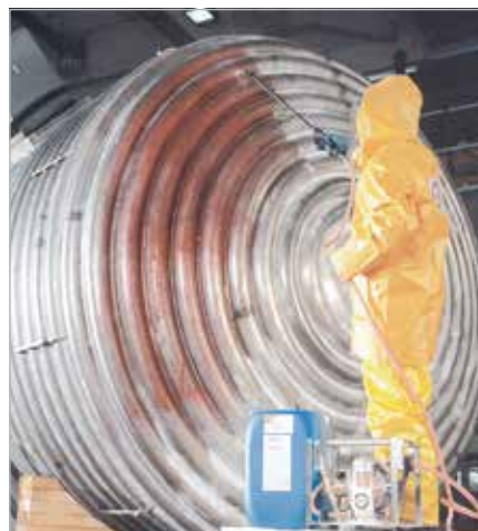
Spray pickling using POLINOX FL AKTIV
